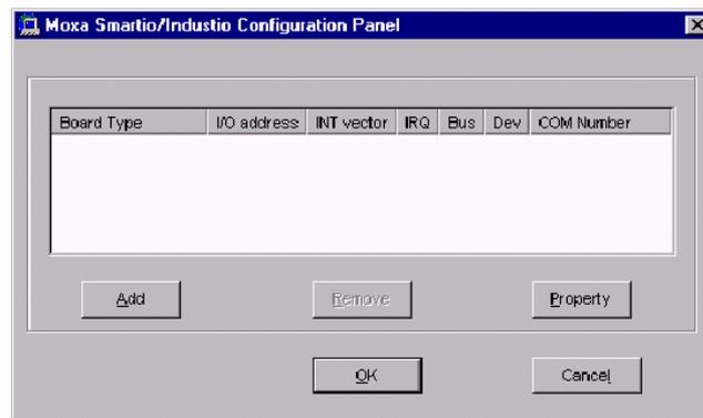
7. В списке «**Board Type**» выберите устанавливаемую плату Industio CP-134U. После этого выберите один из отображенных портов, и для изменения его настроек нажмите на [**Port Setting**].
