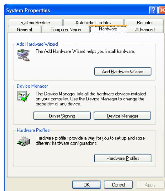
2. Выберите вкладку **Hardware [Устройства]**, а затем нажмите на **Device Manager [Диспетчер устройств]**. Наведите курсор на плату CP-134U, расположенную в списке **Multi-Port serial adapters**, и нажмите на правую кнопку мыши. В появившемся меню выберите пункт **Uninstall... [Удалить]**.
